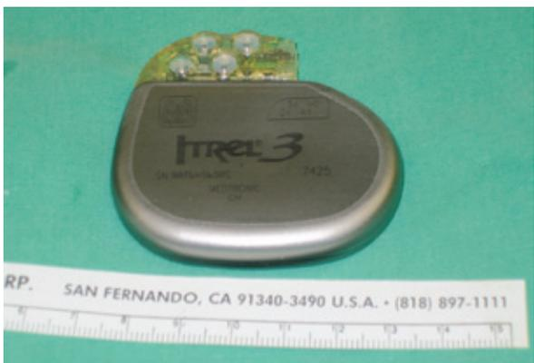
脊髓神經刺激器所用供電電池外觀。電池必須連結刺激晶片，再植入病患胸前或腹部皮下。
