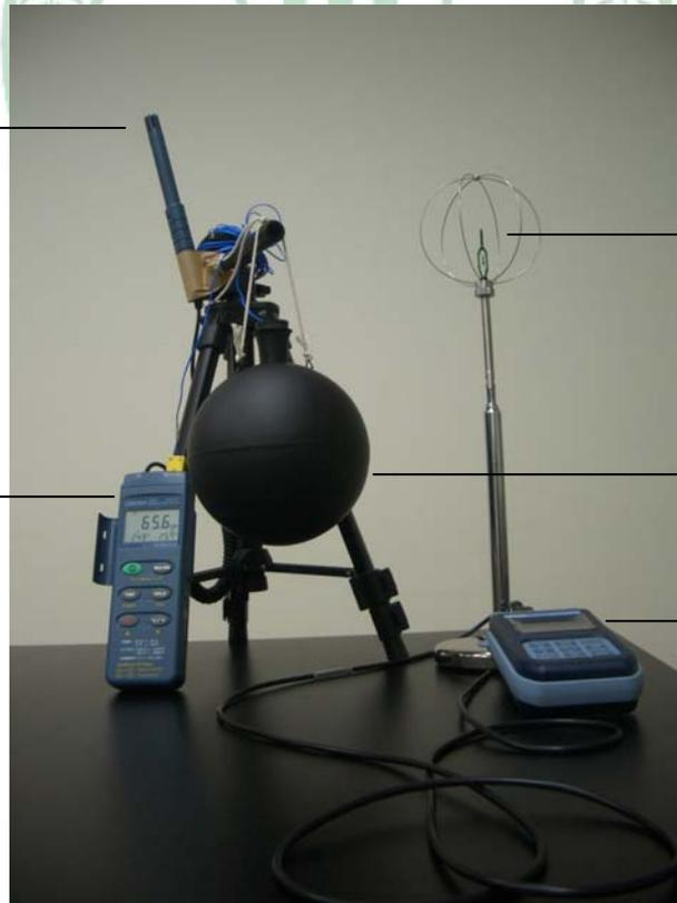
圖 2-4 現場量測用之室內氣候採擷系統
