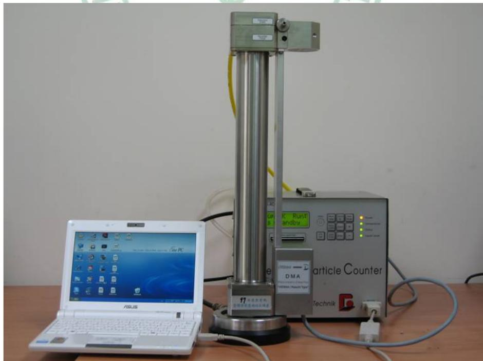
圖 3-6、SMPS 構造示意圖：(a)DMA(H：63 cm) and CPC(26×29×23 cm)，
