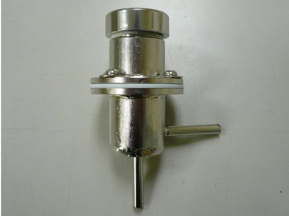
圖 2.2 ISO 6529 浸透測試實驗模型
