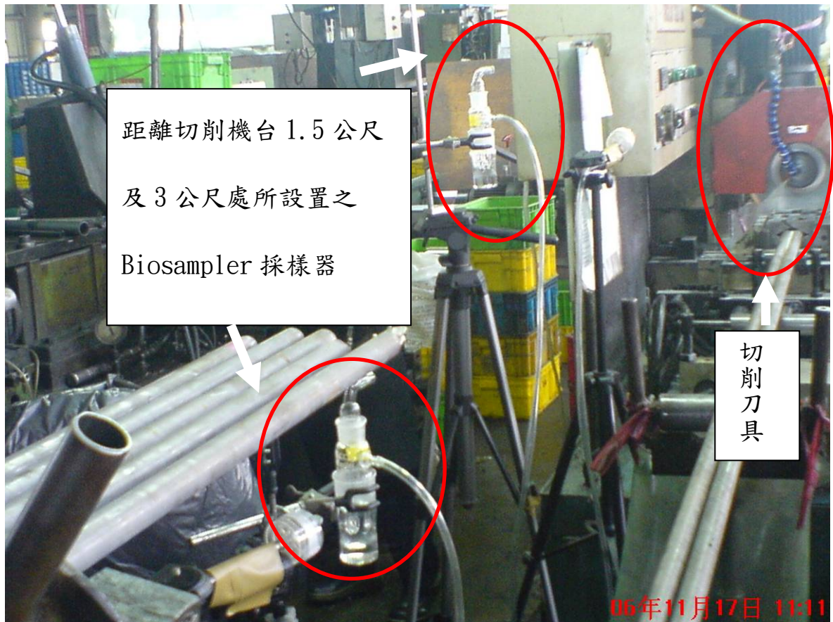
圖八、現場採樣地點。圖中框起來之部分為使用 Biosampler 採樣器及個人採樣泵在距離切削機台 1.5 公尺及 3 公尺處之採樣點進行採樣。
