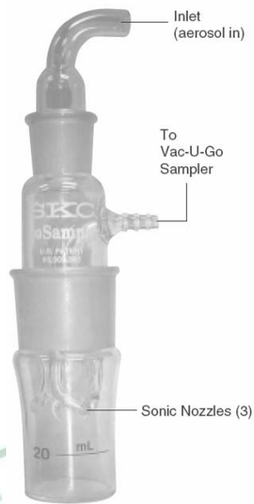
圖二、Biosampler 採樣器。頂端為氣體採樣頭，中間則為連接採樣泵之接頭，底部標示的部份為能使空氣達到音速的噴頭。(取自 SKC 網頁)
