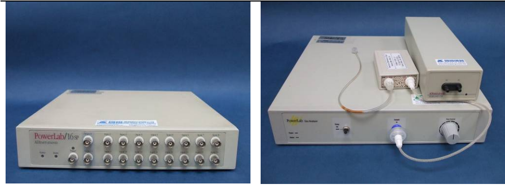
圖 3-5 生理訊號接收放大器 圖 3-6 上為流量計 下為氣體分析儀
