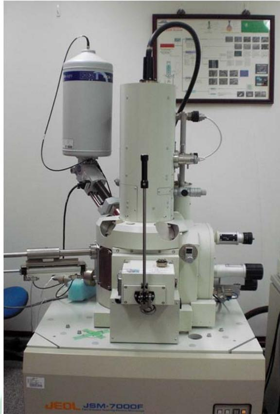
圖 2-25 明道大學場發射型掃描式電子顯微鏡(TF-SEM,JEOL JSM-7000F)
