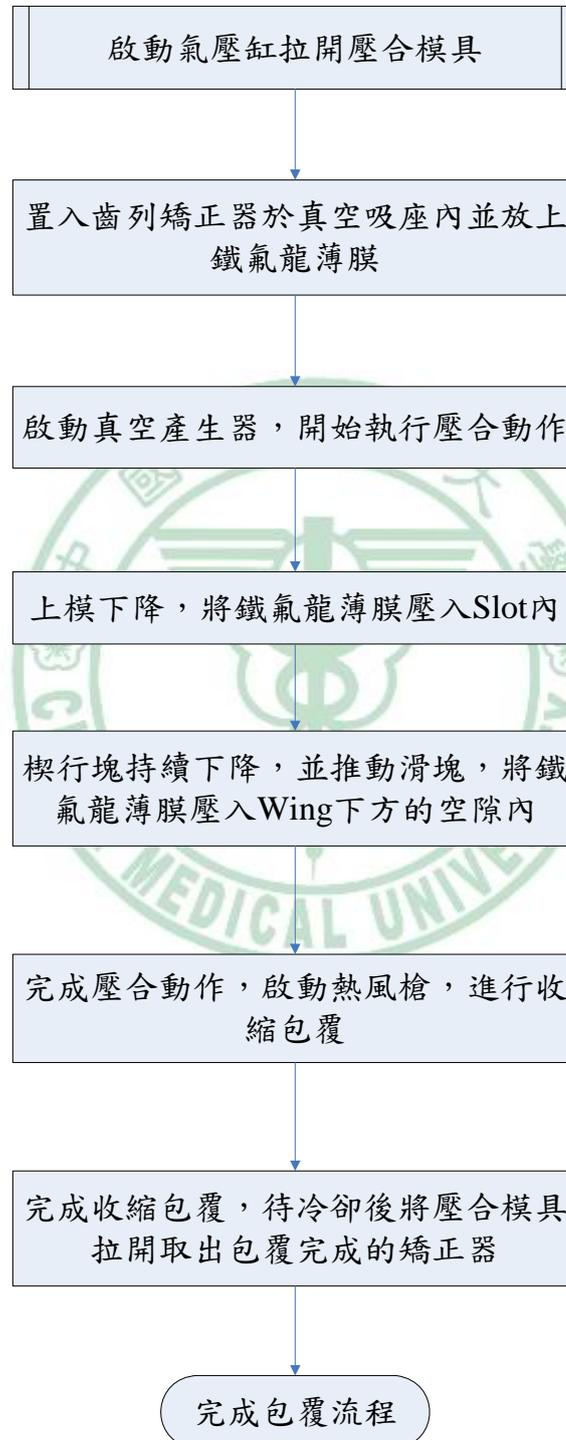
圖 2-14 壓合模具動作流程圖
