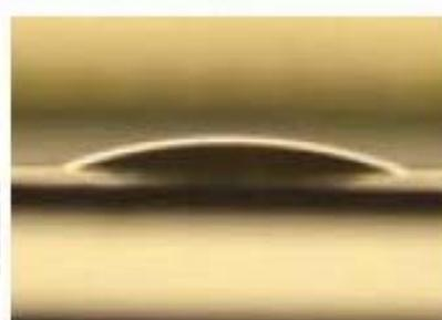
圖 1-12.b PTFE 經電漿處理後靜態接觸角降為  $28.0^\circ$ ，親水性濕潤性提高
