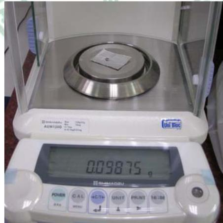
圖 2-27 鋁箔紙加上待測矯正器重量  $P+W_0$
