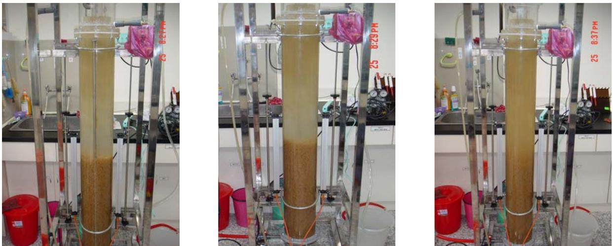
Figure 5-1. 液面下 15 cm (1/10 有效水深) 連續進流污泥之污泥沉降情形
