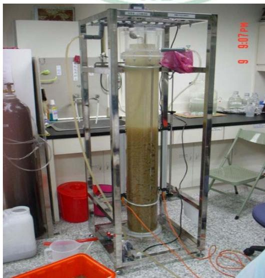
Figure 2-12. 連續式光柵沉降管柱
