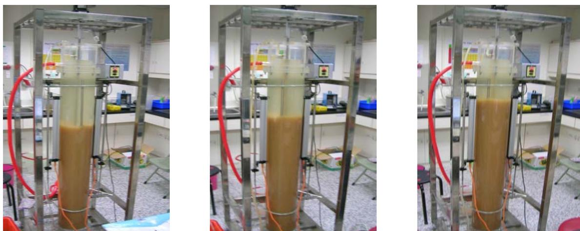
Figure 5-4. 液面下 110 cm (3/4 有效水深) 連續進流污泥之污泥沉降情形
