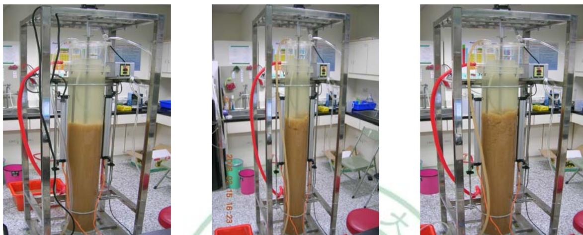
Figure 5-3. 液面下 50 cm (1/3 有效水深) 連續進流污泥之污泥沉降情形
