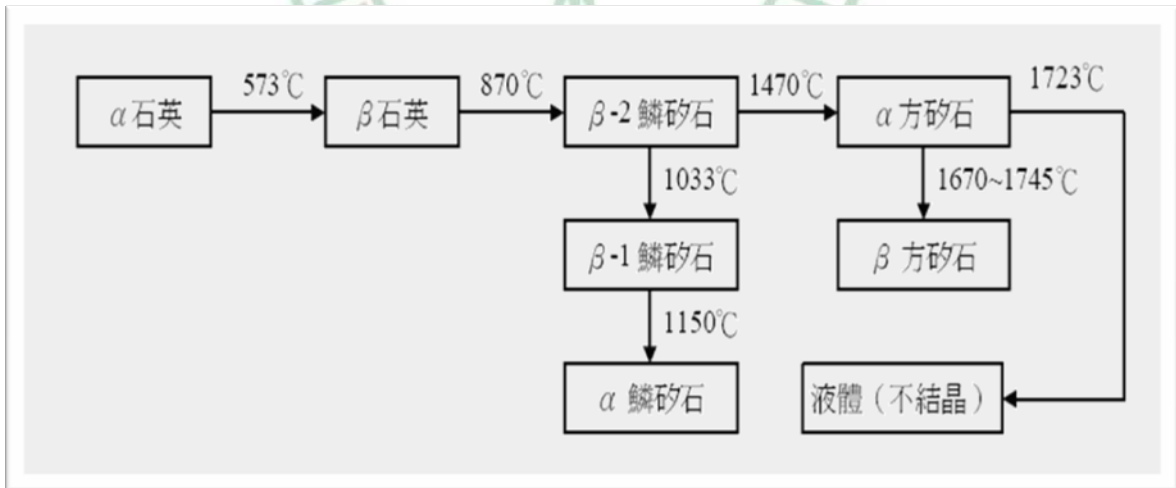
圖六、一大氣壓下結晶型游離二氧化矽之晶形變化圖 [32]
