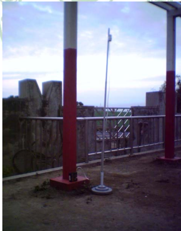
圖 3-2-5 個人式多孔金屬固氣分離器(採樣進行中)
