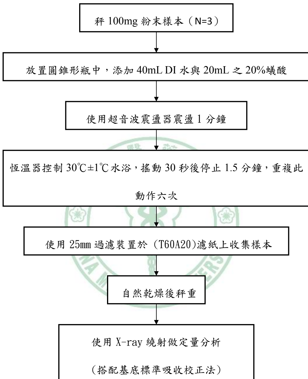
圖四 日本 JIS A1481 石綿分析方法流程
