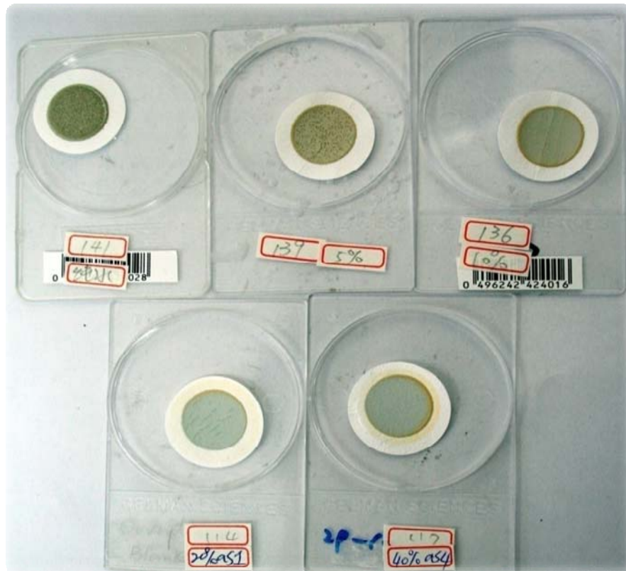
圖十八 不同蟻酸處理自然乾燥後表面現象
