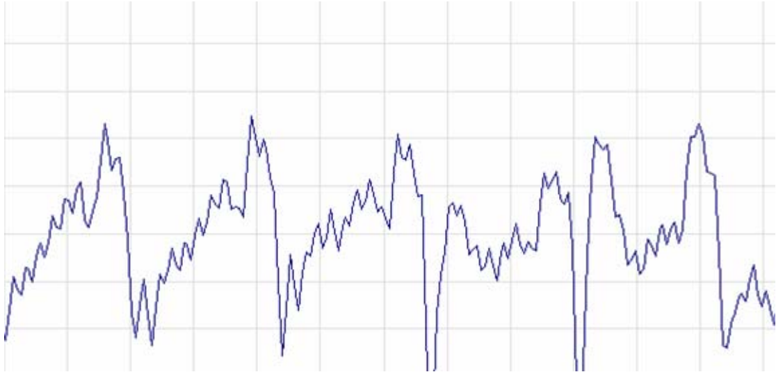
圖 5.7 無法正常辨識的心電圖(動物在抽蓄導致波不明顯)。
