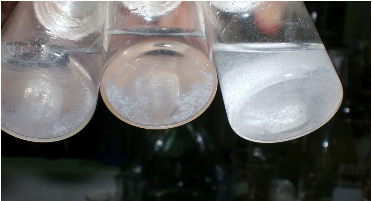
圖三十七、結蘭膠 0.75%蛇床子素奈米膠漿靜置後析出的狀況。
