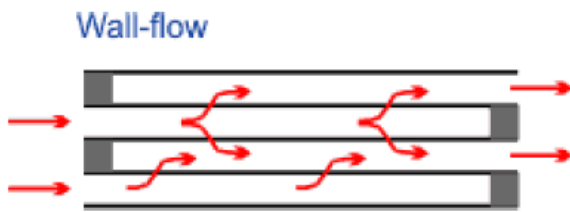
(a) 壁流式(wall-flow)
