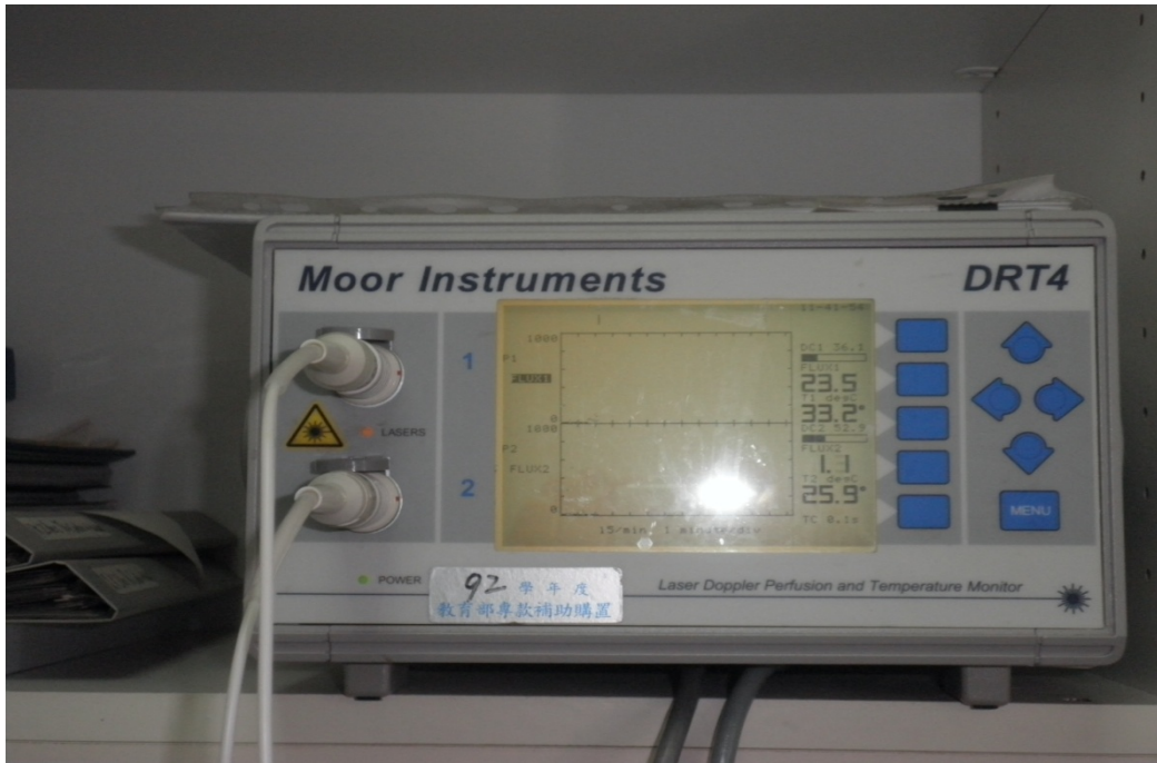
圖 3.1：本研究所使用的 Laser Doppler flowmetry, DRT4 外觀圖
