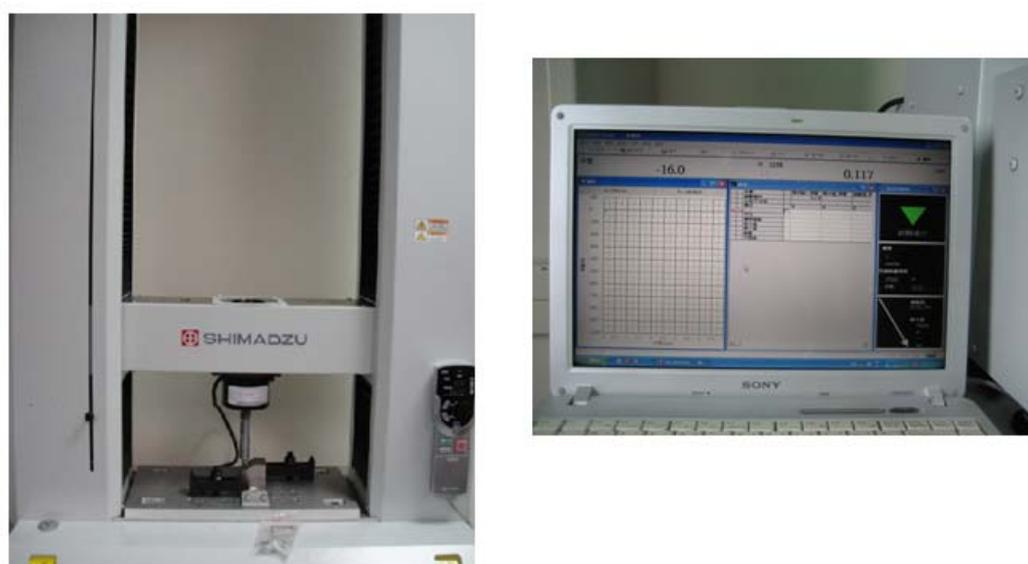
圖 2.14 材料力學測試機系統：(左)材料測試機;(右)控制軟體。
