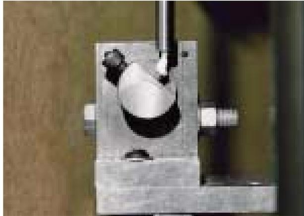
圖 1.6 Kerstein et al[13]之研究裝置，施力與支台齒夾角 40 度。
