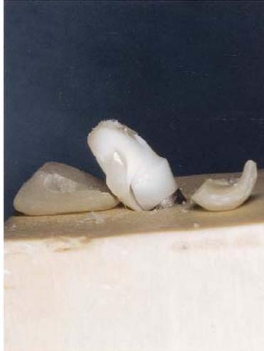
圖 1.3 Yildirim et al(2003) [9]實驗結果，氧化鋯支台齒和全瓷冠破
