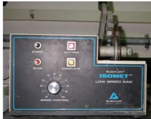
圖 2.22 Isomet 低速切割機將植體組件進行縱向切片，左上角和左下角為試驗研究的人工植體：3i 練習用黃銅之人工植體。
