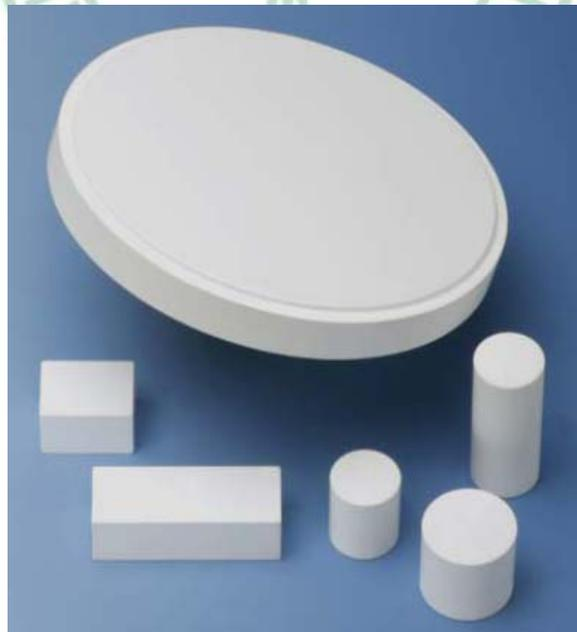
圖 2.6 本研究所使用的預燒結之鋯餅(pre-sintered zirconia)，圖片由
