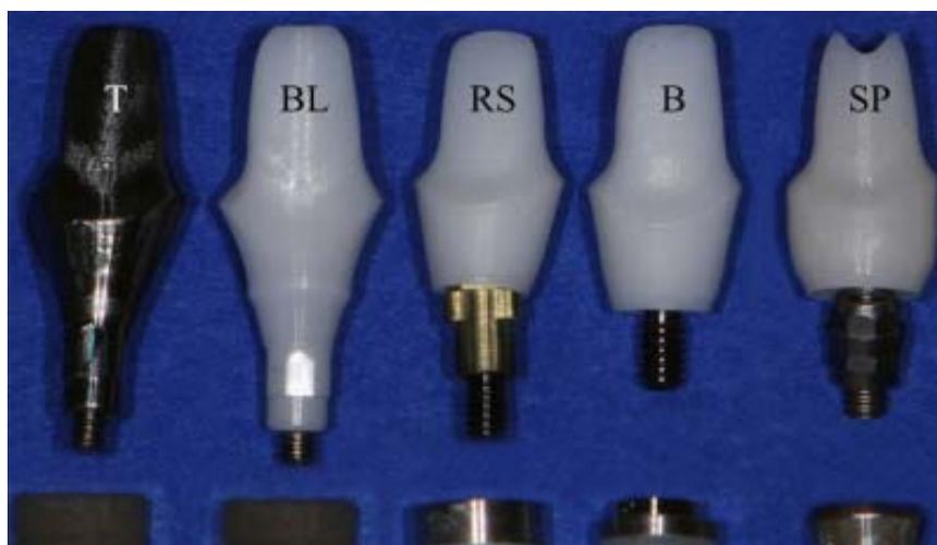
圖 1.24 Truninger TC et al[21]的實驗，由左而右依次：控制組，T 組(鈦支台齒和內接合方式的人工植體)，第一組，BL 組(一件式二氧化鋯支台齒和內接合方式的人工植體)，第二組，RS 組(兩件式二氧化鋯支台齒和內接合方式的人工植體)，第三組，B 組(一件式二氧化鋯支台齒和外接合方式的人工植體)，第四組，SP 組(兩件式二氧化鋯支台齒和內接合方式的人工植體)。
