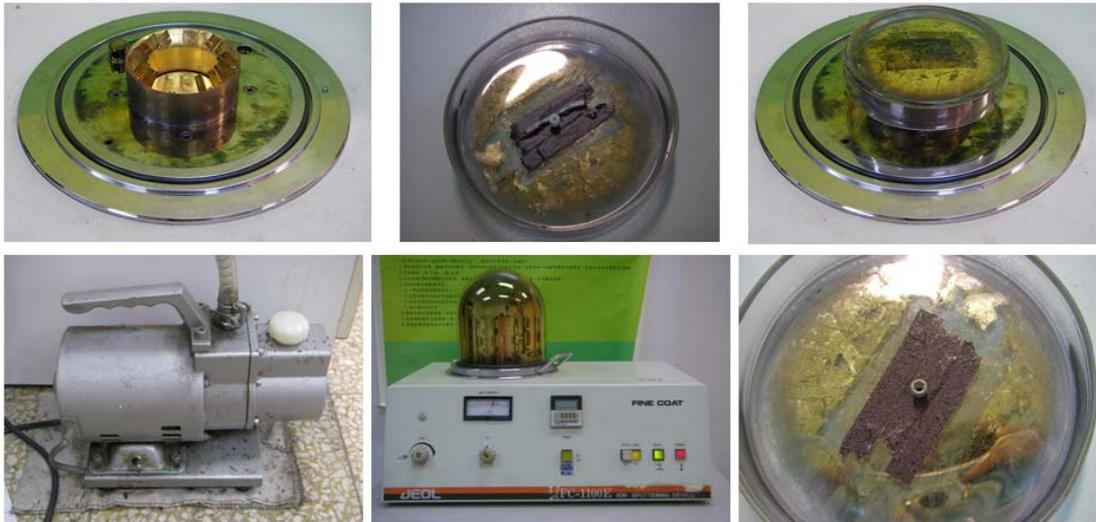
圖 2.23 以離子覆膜機(FC-JEOL, JFC-1100E, Japan) 鍍金於二氧化鋯支台齒。
