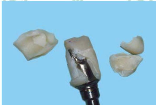
圖 1.12 Kim et al[14] pressable metal ceramic abutment 的碎裂模式。
