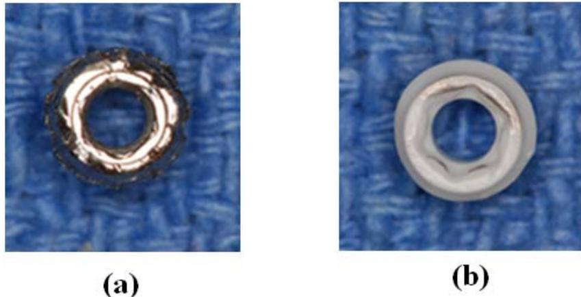
圖 3.16 材料力學測試後檢視支台齒 (和人工植體接觸面視角)：(a)鈦合金支台齒；(b)二氧化鋯支台齒。
