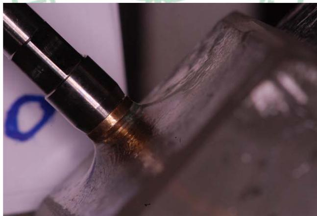
圖 4.1 epoxy resin 硬化後高度不能一致。
