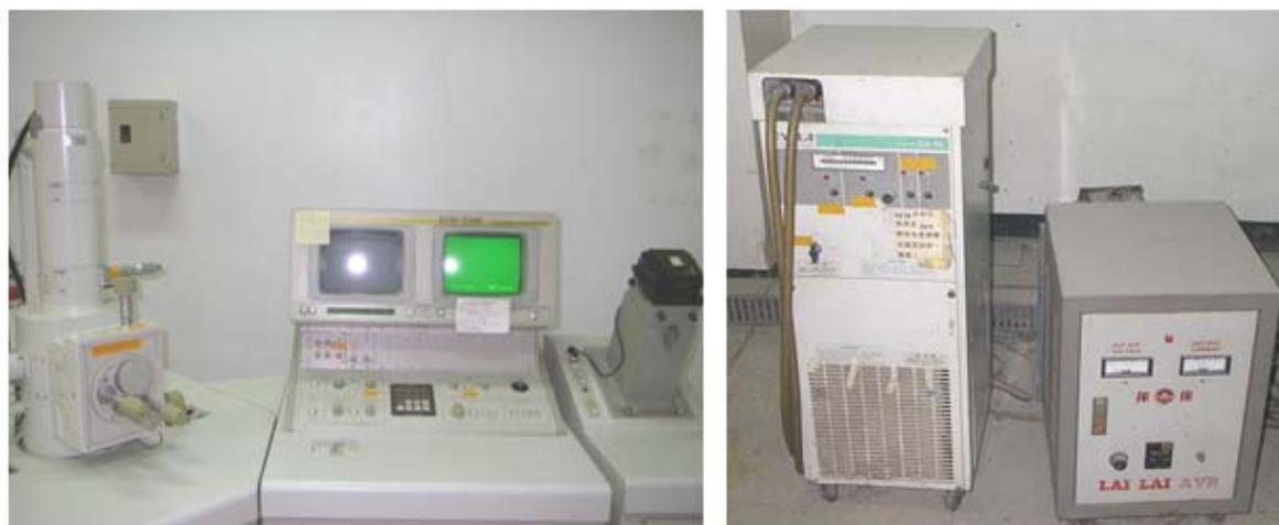
圖 2.20 掃瞄式電子顯微鏡：(左) 電子顯微鏡主基本體；(右) 冷卻水控制器。
