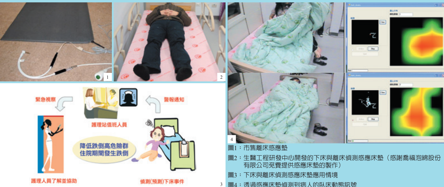
圖4：透過感應床墊偵測到病人的臥床動態訊號
