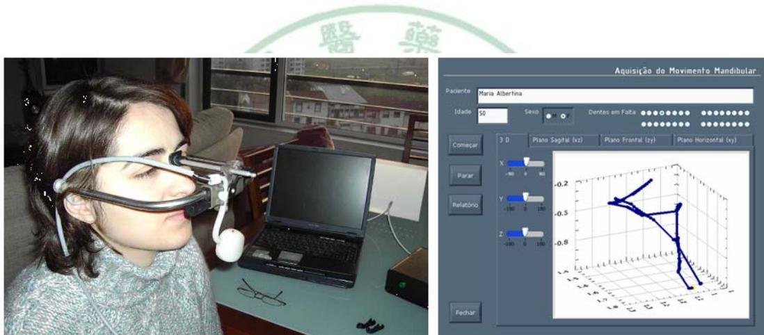
圖 1.8 虛擬實境咬合器，圖左為感應器，接收病患下顎運動的訊息，將資訊傳入電腦中。圖右為電腦軟體，記錄下顎運動的三度空間軌跡。(Santos et al., 2009)
