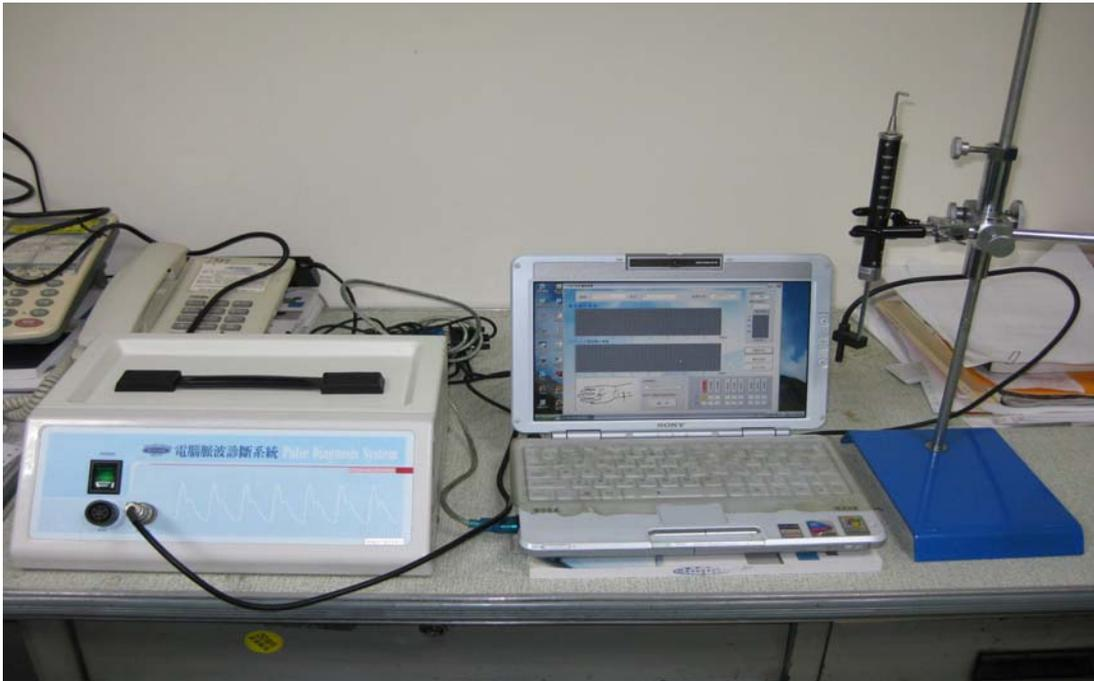
圖 3-2-2 PSD2000 脈診儀、探頭與手提式電腦
