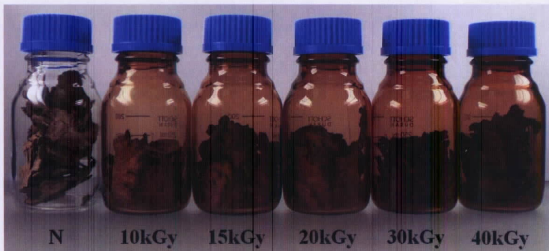
圖三、輻射照射前後之川芎，依次為未照射輻射、照射劑量 10kGy、15kGy、20kGy、30kGy 及 40kGy。
