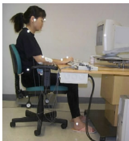
圖 4 動作分析儀反光球位置
