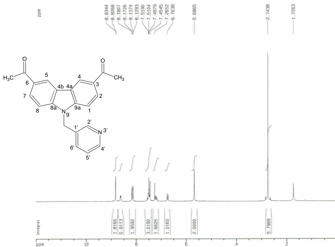
圖 3c-3 化合物 3c 之 1 H-NMR 圖譜(CDCl 3 , 200 MHz)
