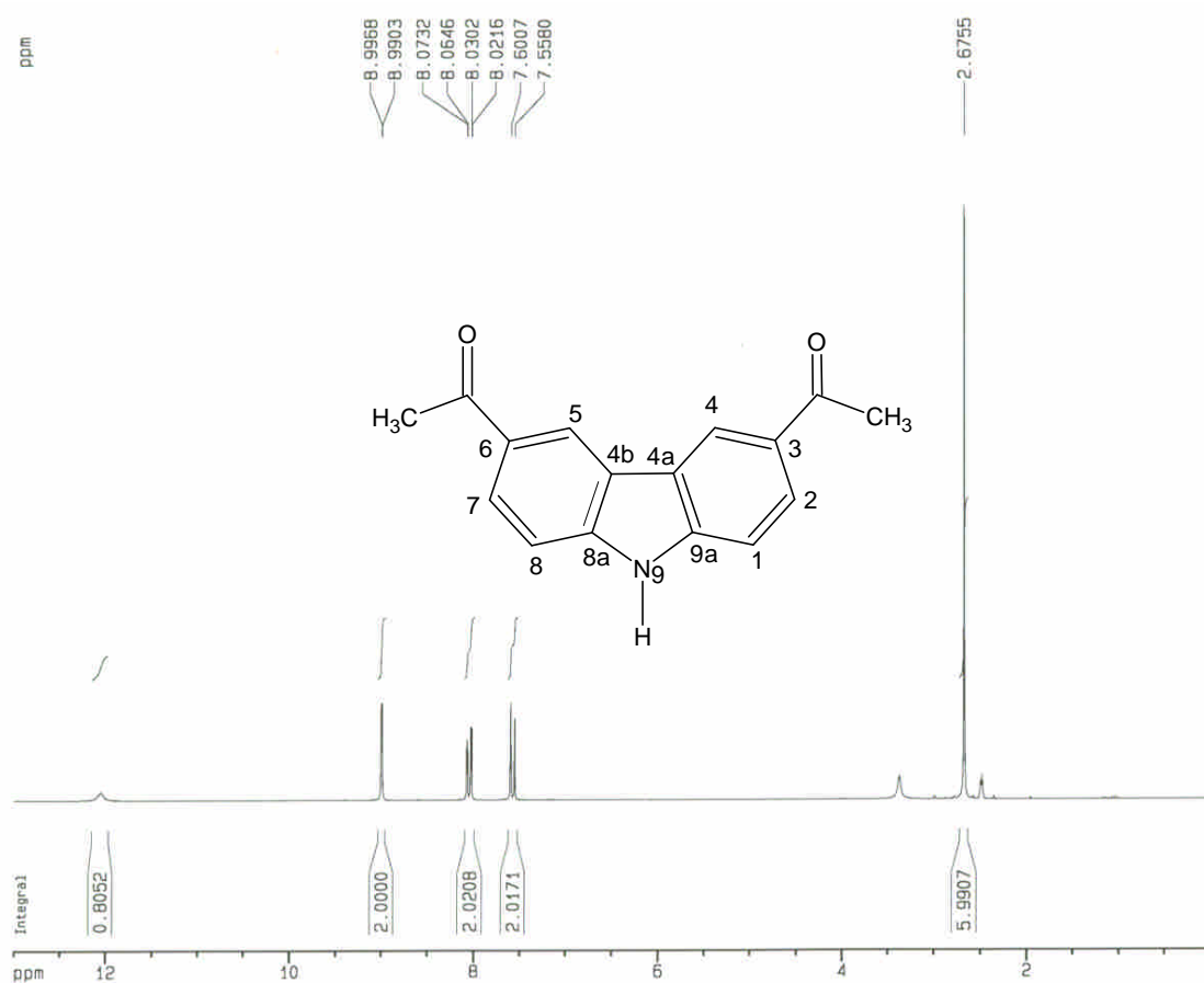
圖 1c-3 化合物 1c 之 ^1\text{H-NMR} 圖譜(DMSO- d_6 , 200 MHz)
