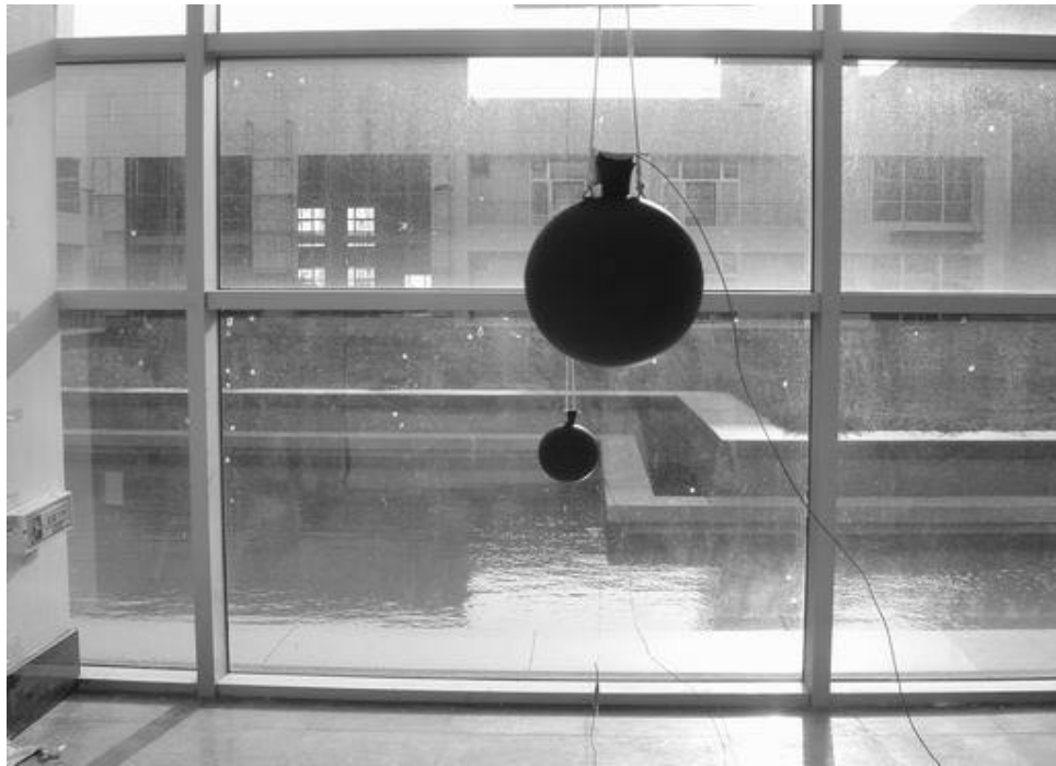
圖 2-8 臨窗區與非臨窗區之輻射溫度量測
