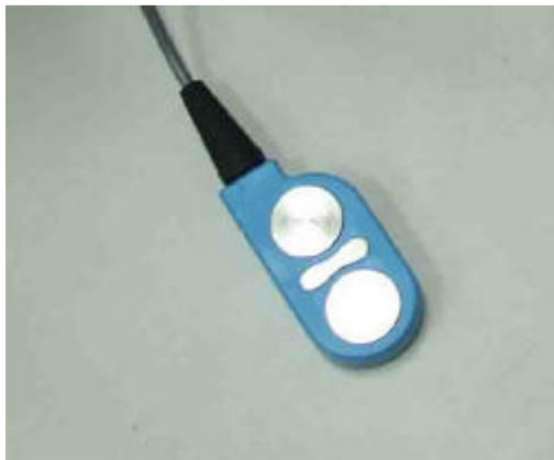
圖 3.5 肌電訊號探頭，收集受測之肌電訊號
