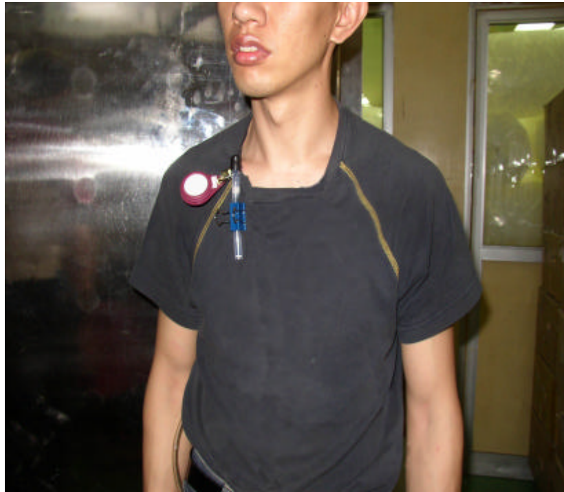
圖 3-3-1 勞工空氣樣本採集示意圖
