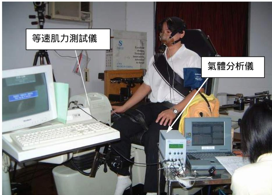
圖二等速肌力測試儀和氣體分析儀
