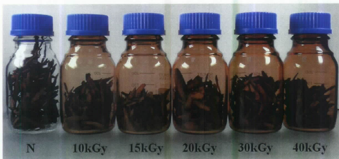
圖四、輻射照射前後之丹參，依次為未照射輻射、照射劑量 10 kGy、15 kGy、20 kGy、30 kGy 及 40 kGy。
