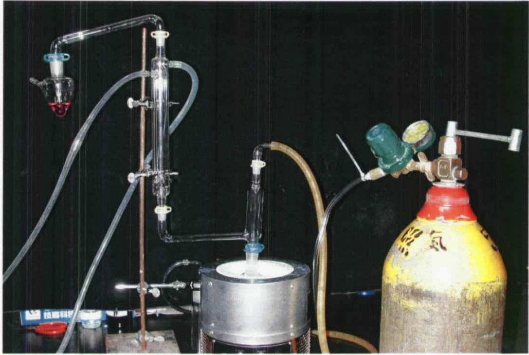
圖九 實驗室通氣蒸餾裝置
