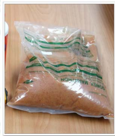
圖 2-22 離子交換樹脂增酸劑，使用時須用細網裝樹脂，之後浸泡在水中，邊攪拌邊量測 pH 值。
