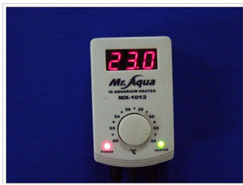
圖 2-17 本實驗所使用的溫度計，本身除了可以量測溫度，還可以連接石英加熱管，進行水溫之控制。
