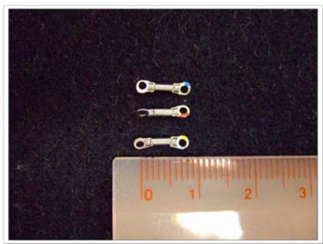
圖 1-4 上面為三種不同力量之 Ni-Ti coil spring，由於 coil spring 本身之長度大約為 9mm，因此彈簧拉開量小於 9mm 之空間則無法使用 coil spring 來關閉。
