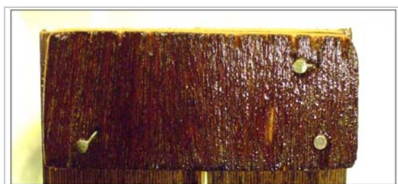
圖 2-12 木板在水中 3 天之情形，由於木頭會吸收水份，恐有尺度變化之虞，於是不考慮使用。
