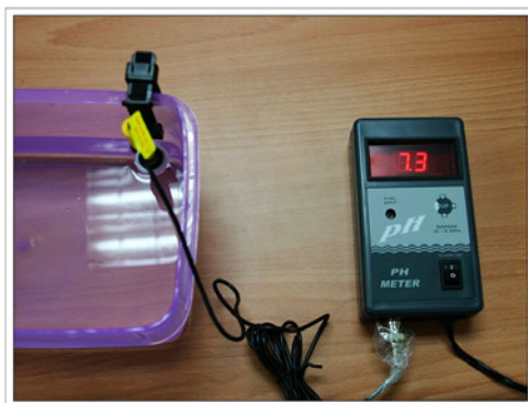
圖 2-19 pH 值測量儀，可測量到小數點以下一位數。
