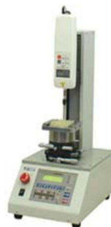
圖 2-20 電子推拉力計及座檯。[30]
