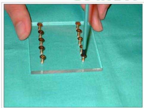
圖 2-13 使用螺絲起子將自攻型木螺絲鎖入。
