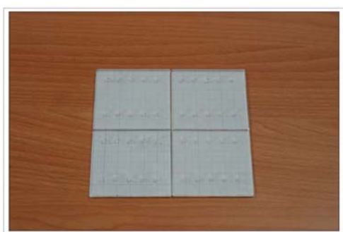
圖 2-11 在壓克力板上黏上方格紙以便精確定位。
