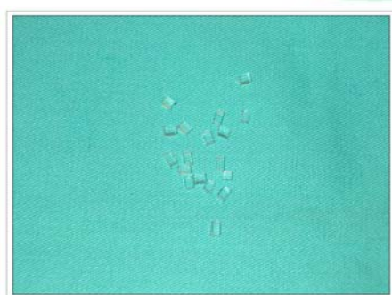
圖 2-9 小壓克力塊之尺寸為長寬均為 2mm，高為 3mm，用以黏著在壓克力板上。
